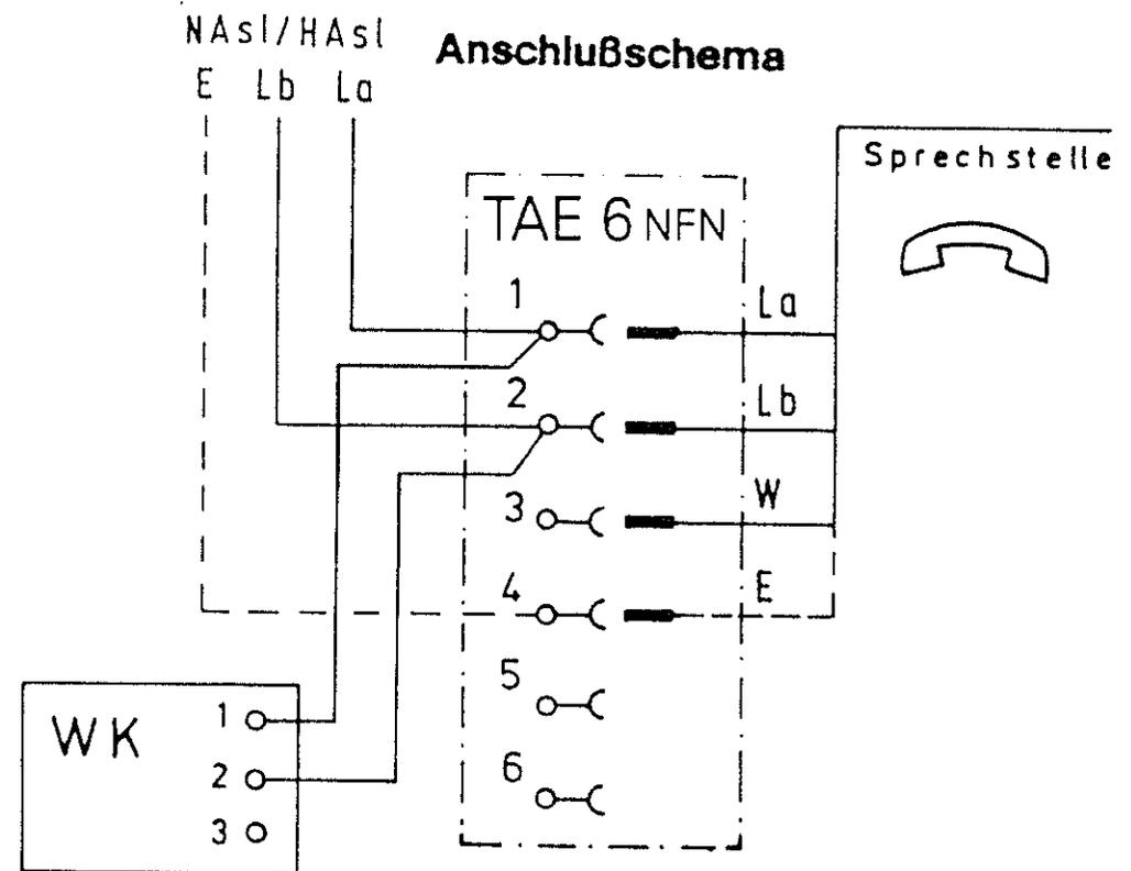
Dieses Anschlußschema wird verwendet, wenn der Telefonapparat keine W-Ader besitzt.
